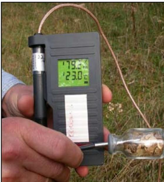
**Abbildung 6** Überprüfen der Feuchtigkeit einer Samenprobe im Feld mit Hilfe eines Hygrometers. (© RBG Kew)
