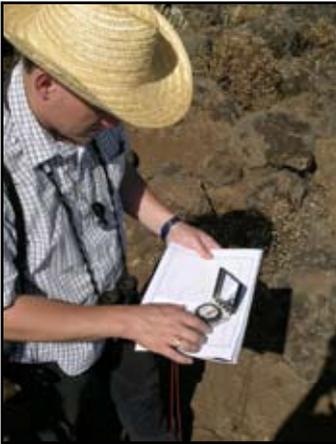
**Abbildung 13.** Messung der Geländeneigung.
